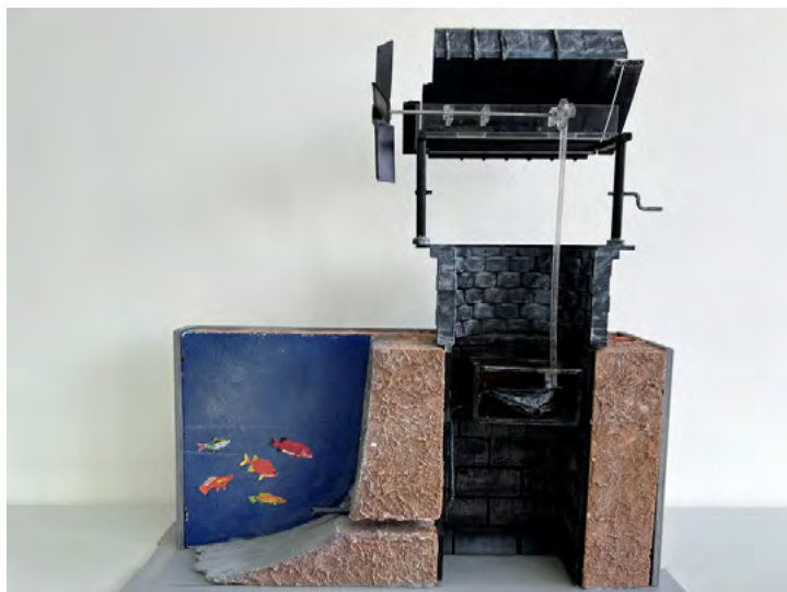
Рис. 2. Макет готового устройства для аэрации зарыбленных водоёмов в зимний период
