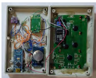
Рис. 2. Внутреннее устройство метеостанции
